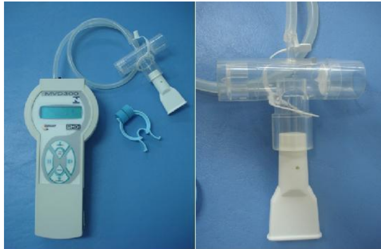
Figura 1 - Manovacômetero digital e válvula unidirecional utilizados para medida das pressões respiratórias máximas
